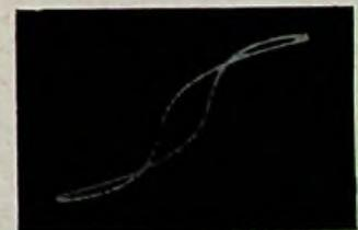
Abb. 19. Hysteresisschleife verzerrt durch Phasenfehler des Meßverstärkers
