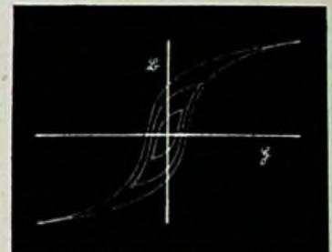
Abb. 18. Hysteresisschleifen nach Schaltung Abb. 17
